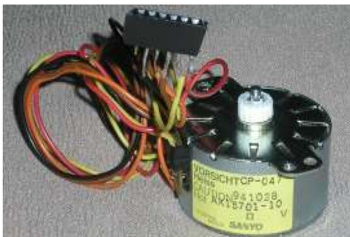
Figura 3.7 – Motor de Passo
