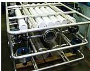
**Figura 2.3 – Protótipo de Robô Submarino**
