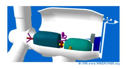
Gôndola:contém os componentes chaves do aerogerador. Pás do rotor:captura o vento e transmite sua potência até o cubo que está acoplado ao eixo de baixa velocidade.
