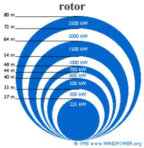
A figura dá uma idéia dos tamanhos normais dos aerogeradores. Uma turbina típica com um gerador elétrico de 600 kW possui um rotor de 44 m. Dobrando-se o diâmetro obtêm-se uma área quatro vezes maior. Significa uma potência também de quatro vezes maior.
