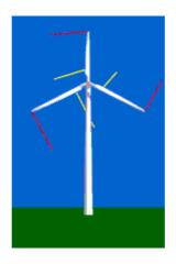
Para estudar como o vento se move com respeito as pás do rotor de um aerogerador, vamos fixar um traço vermelho nos extremos das pás e amarelo a uma distância do cubo de ½ do comprimento da pá. Se a velocidade na ponta da pá for de 64 m/s a um quarto do centro será de 16 m/s.
